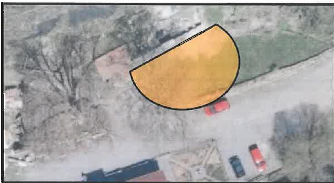
Abb. 5: Bereich vor dem Stolleneingang, der dauerhaft von einer Bestrahlung durch Lampen freizuhalten ist (Radius ca. 10 Meter).
