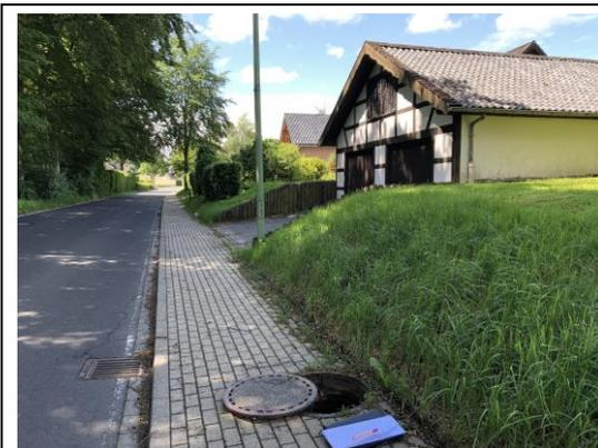
Abb. 3 – Entwässerungsgraben im Gehweg des Kirschensteinwegs, verrohrt
